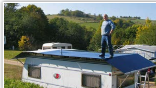
Komplett begehrbares Dach durch Kederverschweißung
